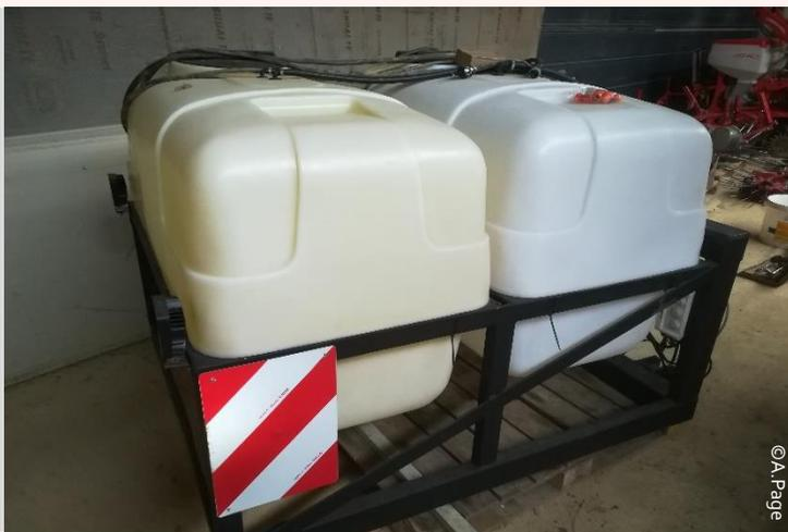
Double cuve (600L) engrais et herbicide, adaptée sur mesure
